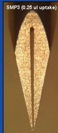
SMP3 nebo SMP2 jehly (Telechem), kapacita 0.25 \mu\text{l} , nanášení 600 pl, průměr tečky 90 až 100 \mu\text{m}
