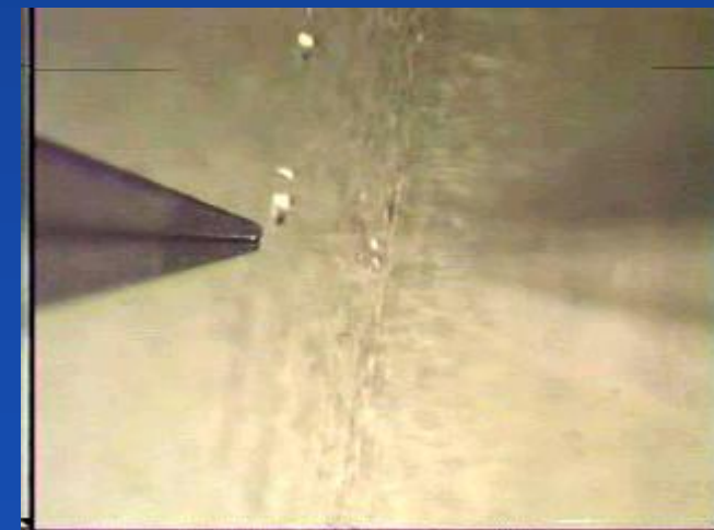
SMP3 nebo SMP2 jehly (Telechem), kapacita 0.25 \mu\text{l} , nanášení 600 pl, průměr tečky 90 až 100 \mu\text{m}
