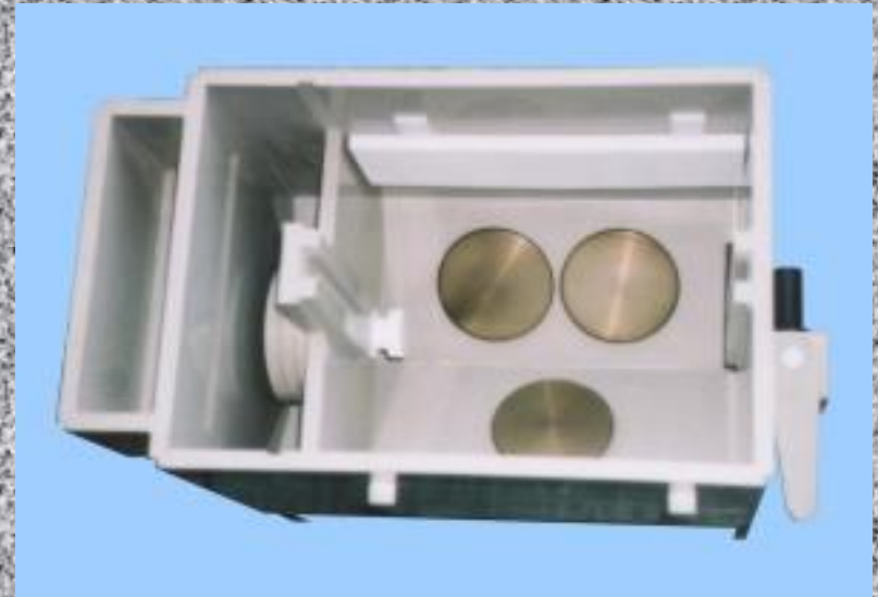
Ultrazvuková lázeň - pohled shora (okrouhlé destičky jsou zdroje ultrazvuku)
